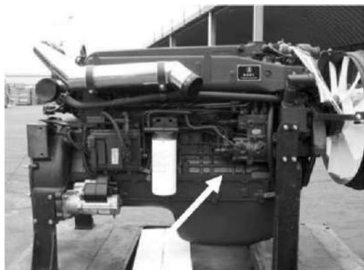
Рис. 6. Место гравировки заводского номера
