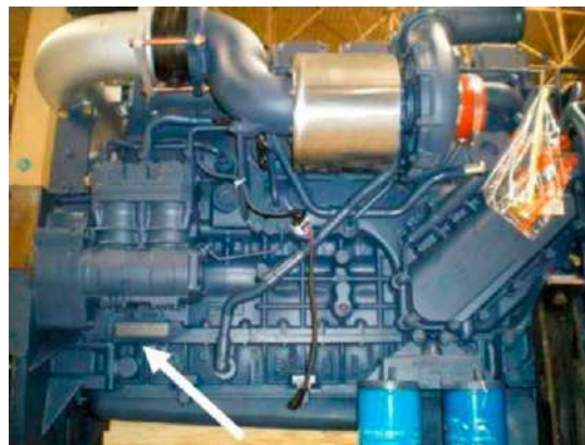
Рис. 7. Место гравировки заводского номера
