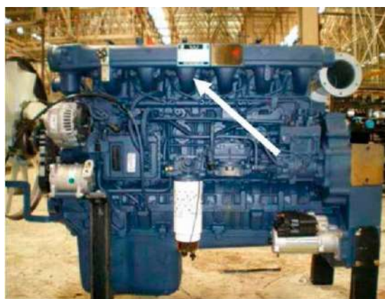
Рис. 5. Место установки заводской таблички на моторе
