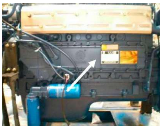
Рис. 4. Место установки заводской таблички на моторе
